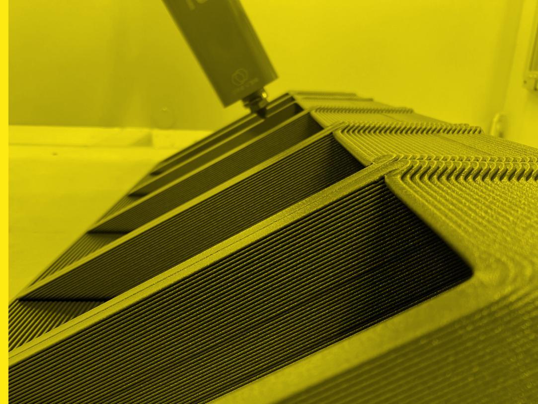
Les taux de déposition élevés, jusqu'à 25 ou 60 kg (55 ou 132 lb) par heure, avec l'impression 3D par extrusion de granulés se traduisent par *des temps d'impression plus courts*, ce qui permet d'imprimer de grandes pièces en quelques jours au lieu de quelques semaines.
